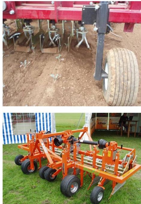
Slika 16 Zupčasta pljevilica s okomitom osovinom Izvor: PAN Europe. 2023.
